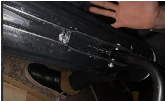
6. Ota esiin etupuskuri. Avaa siinä olevat pultit, ja kiinnitä niillä etupuskuri moottorikelkan etuosaan.
