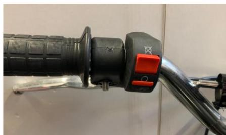
Käynnistys: Aseta virtakytkin RUN-asentoon kuten kuvassa
